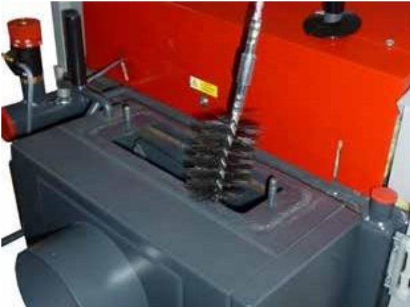
Приклад очищення димових шлях із дротяною щіткою - верхня кришка
