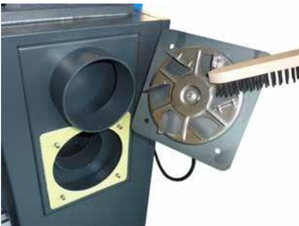
Приклад очищення робочого колеса та перевірки правоти лопатевого вентилятора на вилучення
