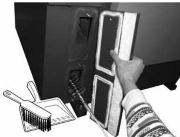
Приклад очищення димовим способом – знизу кришка (по обидва боки)
