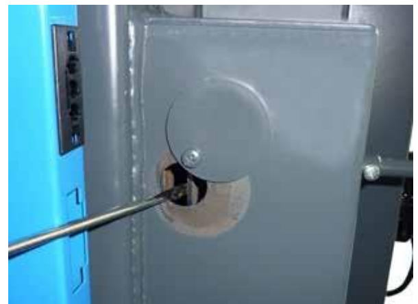
Перевірка та очищення регулювання первинного вторинного повітря через коефіцієнт очищення кришкою
